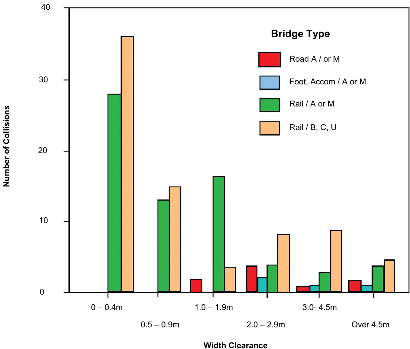
**FIG A/2 DISTRIBUTION OF BRIDGE SUPPORT COLLISIONS
