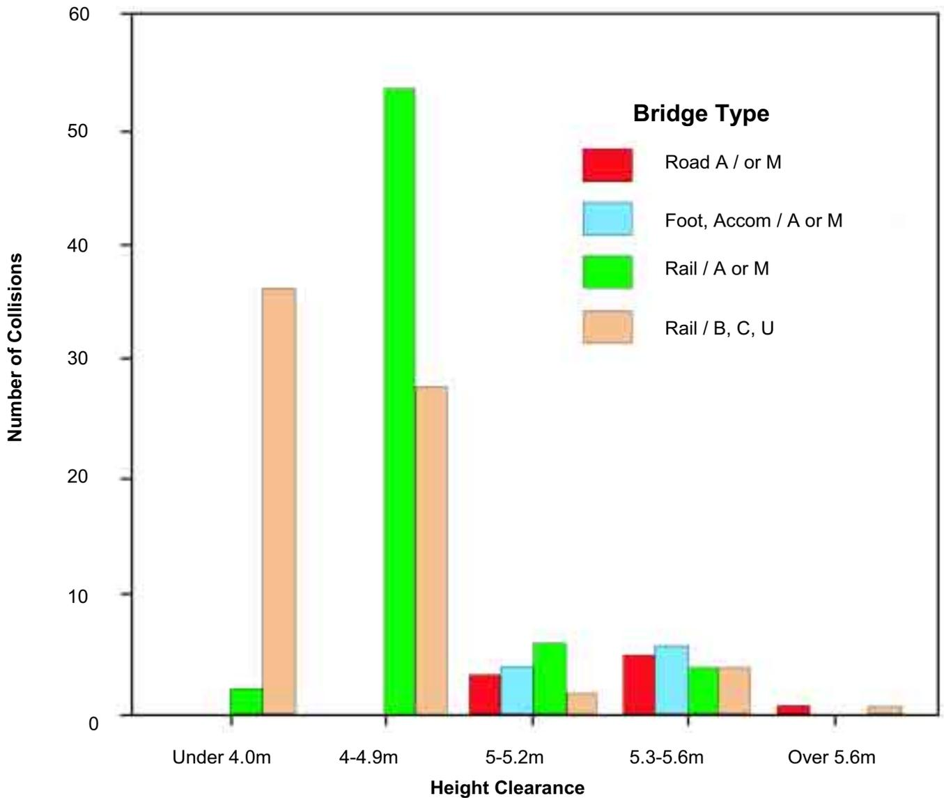
**FIG A/1 DISTRIBUTION OF BRIDGE DECK COLLISIONS
