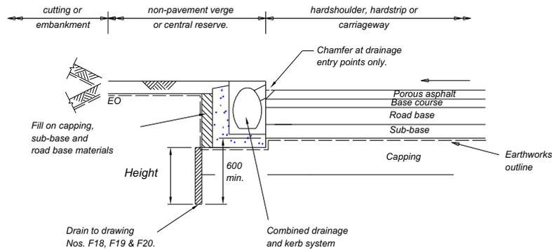
**TYPE Sk5B - COMBINED DRAINAGE AND KERB SYSTEM**
